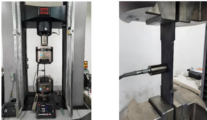
图 2 利用 MTS 拉伸机标定声弹性系数
